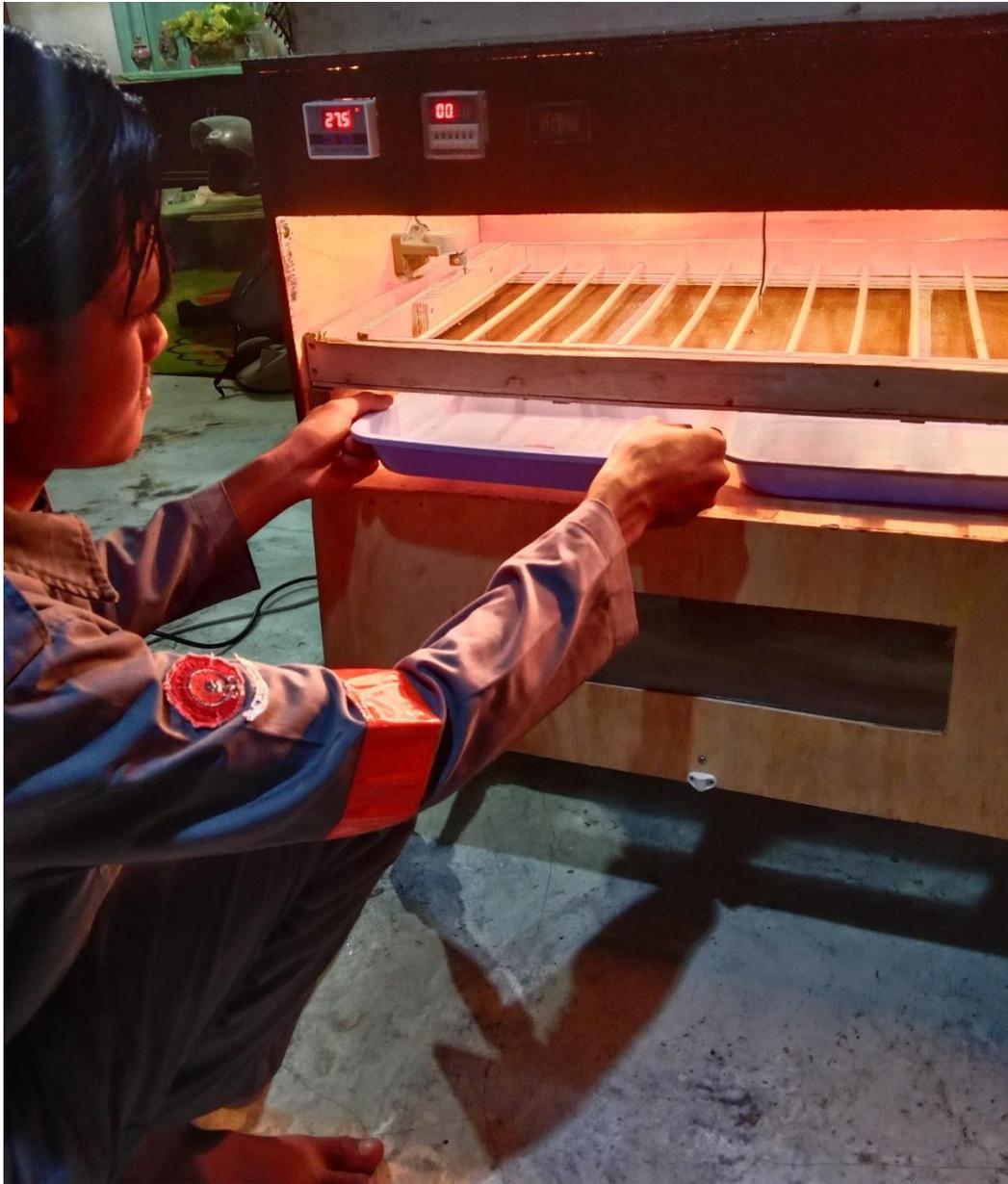
**Gambar 4.12** *Penambahan Air pada Mesin Tetas Telur Otomatis*
