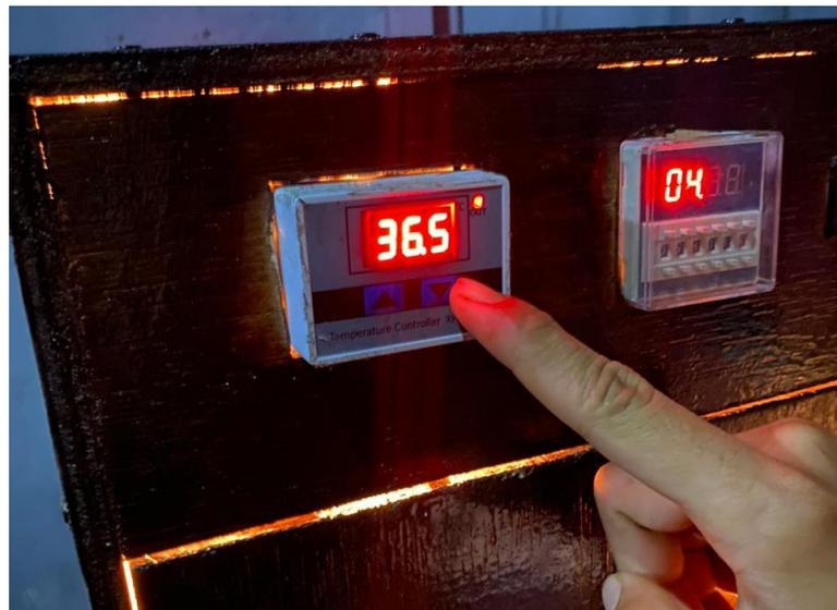
**Gambar 4.9** Pengaturan Suhu Kerja Mesin Tetas Telur
