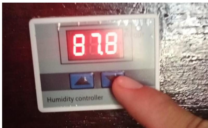
**Gambar 4.11** *Pengaturan Kelembaban Udara Mesin Tetas Telur*
