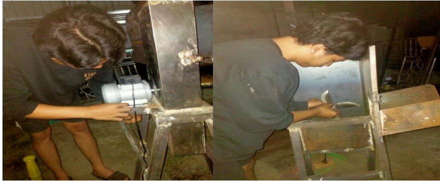
Gambar 4.4 Proses Pemasangan Motor Listrik Dan Mata Pisau
