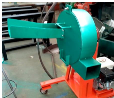
Gambar 2.1 Mesin Pencacah Rumput Chopper
