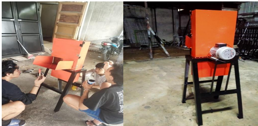
Gambar 4.5 Proses Pengecatan Mesin Pencacah Rumput
