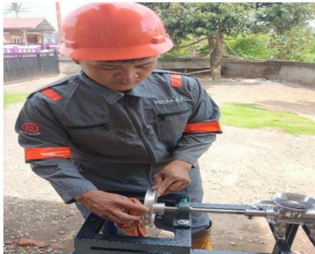
**Gambar 4.8** proses perawatan pada pulley
