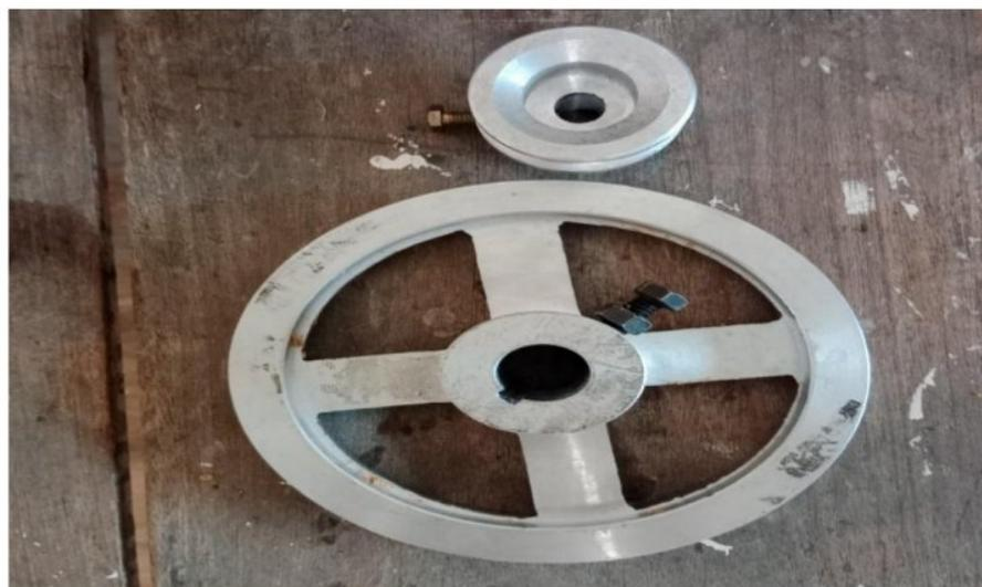
**Gambar 4.3** *pulley* penggerak
