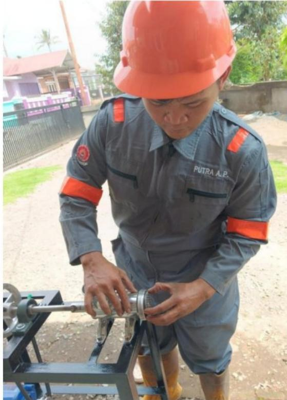
memastikan permukaan *grinder* dalam kondisi normal. Gambar proses perawatan grinder dapat di lihat pada gambar 4.6.
