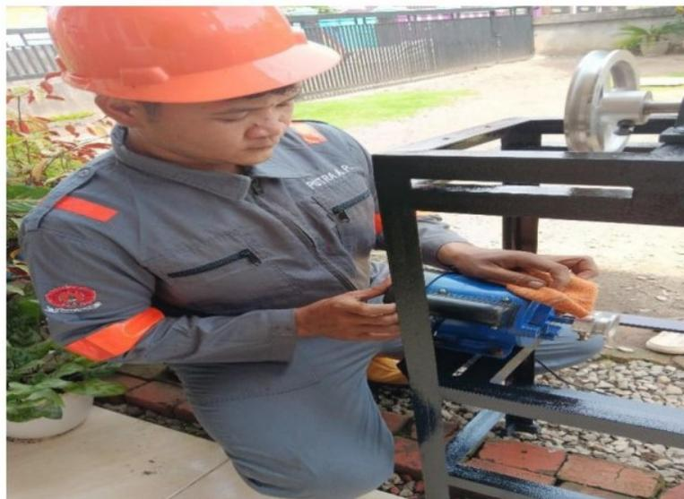
**Gambar 4.10** proses perawatan pada motor listrik
