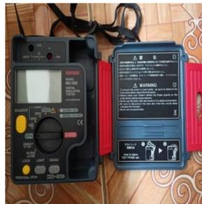
**Gambar 4.1 Magger Alat Yang Digunakan**
