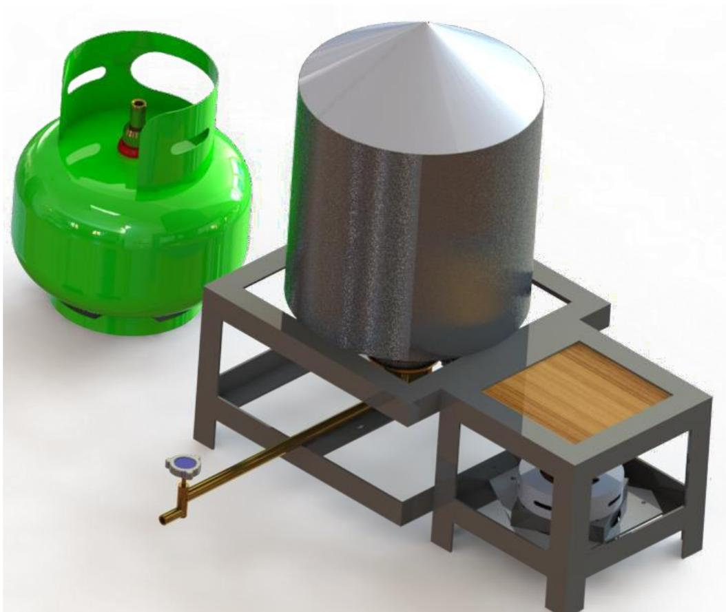
**Gambar 3.1** Rancangan Mesin Pemasak Lemang
