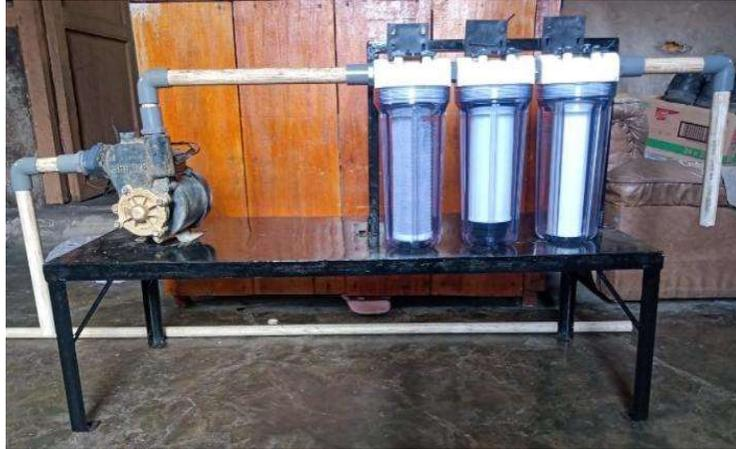
**Gambar 4.4** Alat Filterisasi Air
