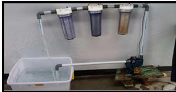
**Gambar 2.1** Alat Filterisasi Air
