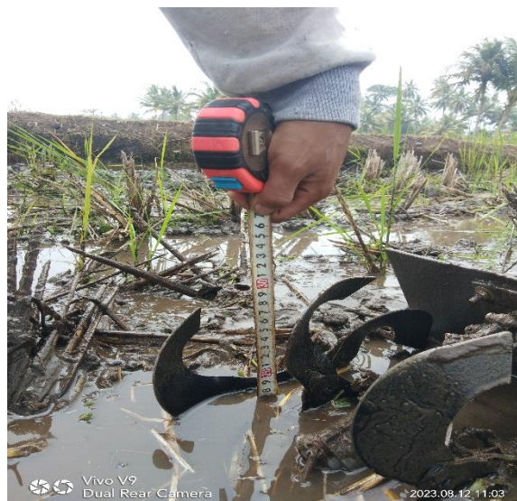
Gambar 4.17 Pengukuran Kedalaman Kerja Sumber : Dokumen Pribadi
