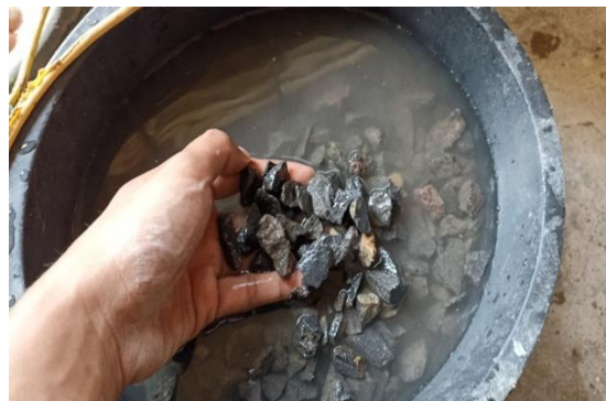
Gambar 3.5 Pengukuran kadar lumpur agregat kasar Sumber : Dokumentasi pribadi
