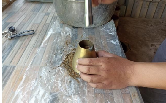
Gambar 3.7 Pengukuran SSD menggunakan kerucut
