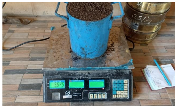
Gambar 3.9 Pengujian berat isi agregat halus
