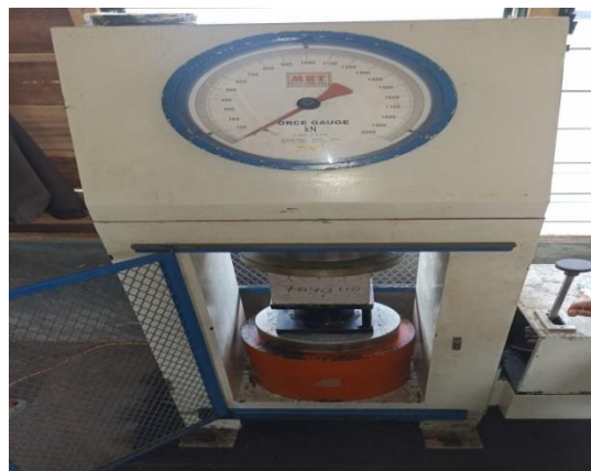
Gambar 3.11 Pengujian kuat tekan beton
