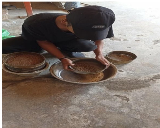
Gambar 3.2 Analisa saringan agregat halus Sumber : Dokumentasi pribadi
