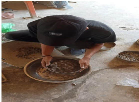
Gambar 3.3 Analisa saringan agregat kasar Sumber : Dokumentasi pribadi
