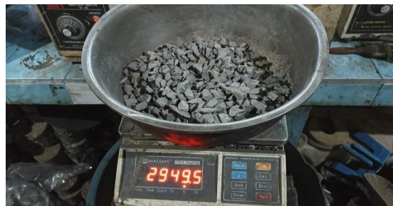
Gambar 3.8 Pengujian berat jenis agregat kasar
