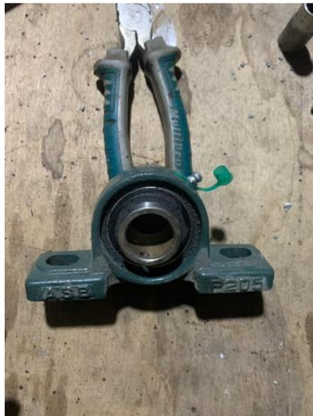
Gambar 4.8 Perawatan Pada Bagian *Pillow Block Bearing*
