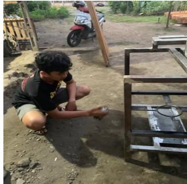
Gambar 4.1 Perawatan Pada Bagian Rangka
