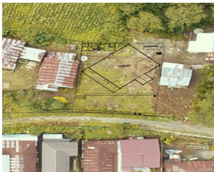
Gambar 3.3 Denah Lokasi pembangunan Masjid Baiturrahim
