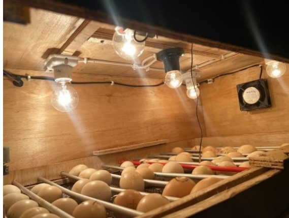
Gambar 4.2 Instalasi Rangkaian Lampu Pemanas
