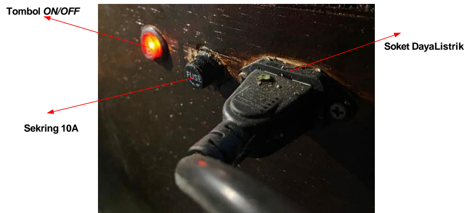
Gambar 4.6 Modul ON/OFF dan Modul Pengaman Kelistrikan
