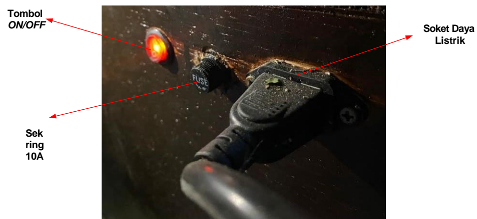
Gambar 3.7 Modul ON/OFF Mesin dan Pengaman Kelistrikan
