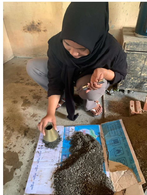
Pengujian berat jenis dan penyerapan agregat halus( Pasir dan Abu batu)
