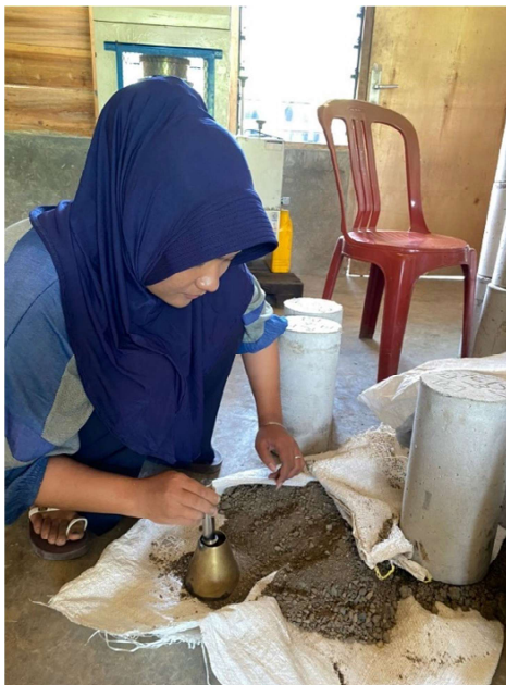
Pengujian berat jenis dan penyerapan agregat halus( Pasir dan Abu batu)
