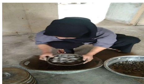
Gambar 4.2 Analisa saringan agregat kasar
