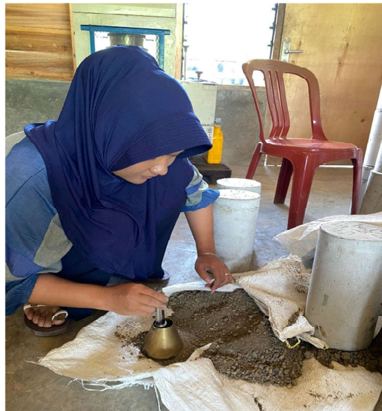
Gambar 4.6 Pengukuran SSD menggunakan kerucut
