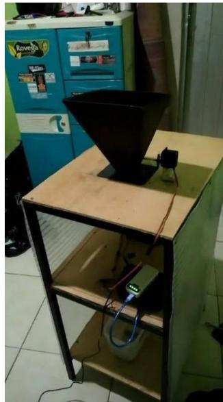
Gambar 2. 4 Alat Pembersih Beras Otomatis Berbasis Arduino
