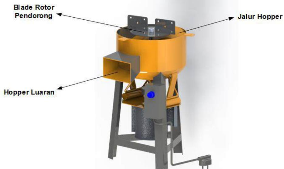
**Gambar 4.4** Pemosisian Komponen Penyusun Mesin Pemecah Buah Pala
