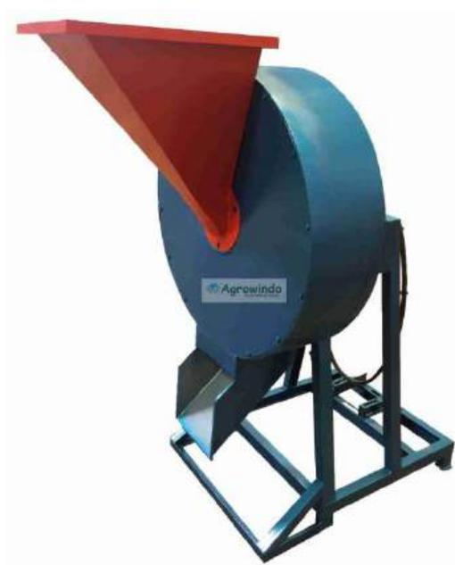
**Gambar 2.6** Mesin Pemecah Buah Pala [10]
