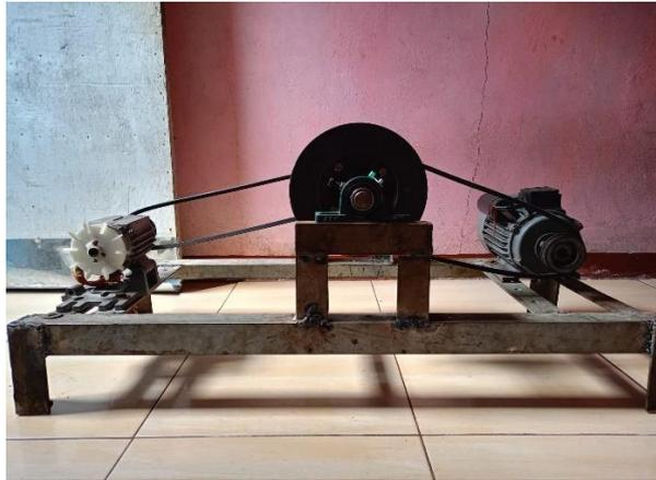
**Gambar 4.3** Proses pembuatan alat utama pemanfaatan putaran flywheel sebagai sumber daya listrik pengolahan emas
