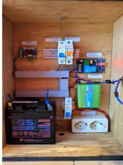
**Gambar 4.4** Proses pembuatan panel kontrol pemanfaatan putaran flywheel sebagai sumber daya listrik pengolahan emas
