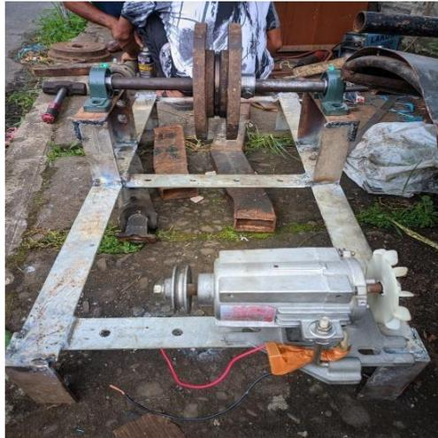
**Gambar 4.2** Proses pembuatan rangka Pemanfaatan putaran flywheel sebagai sumber daya listrik pengolahan emas
